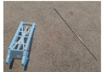
7. Klebe die Stahlstangen mit Sekundenkleber in der Nut ein
