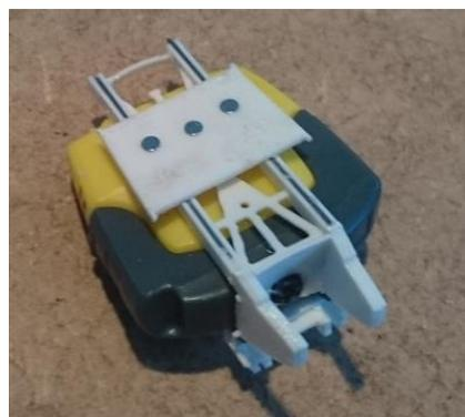
8. Nehme 1x 2 mm Magnet und drücke diese im Mittelloch, und Schraube die Seitenteile mit den M1 schrauben fest.
